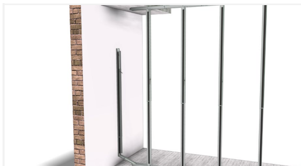
Dépliez les profils horizontaux.
