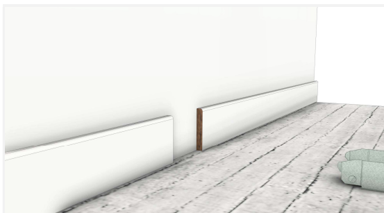
Maak een uitsparing in de plint ter breedte van de wand.
