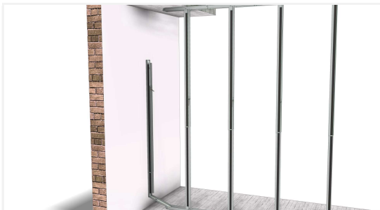
Klap de horizontale profielen uit.
